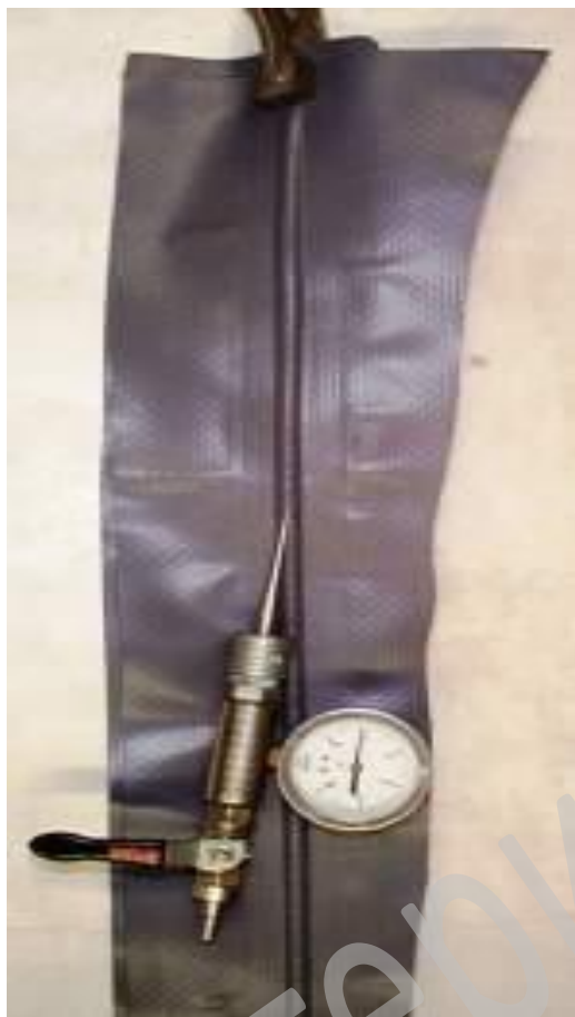
Рис. 8 – Испытательное давление в зависимости от температуры геомембраны, во время испытания сжатым воздухом. Шов считается герметичным, если через 10 минут давление в шве упадет не более, чем на 10%.
