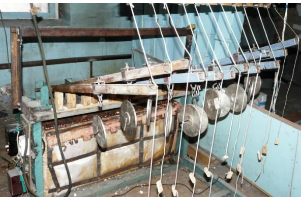
Рис. 16. Установка для испытаний на длительное растяжение
