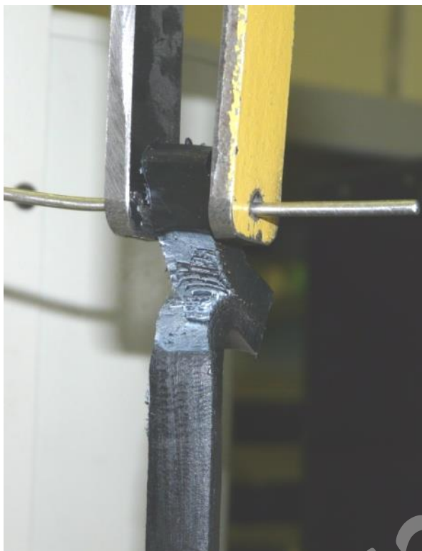
Рис. 32. Процесс отслаивания при испытаниях по ISO 13954
