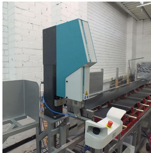
Внешний вид установки для ультразвуковой сварки георешеток (фото: «ВИНДЭК»)
