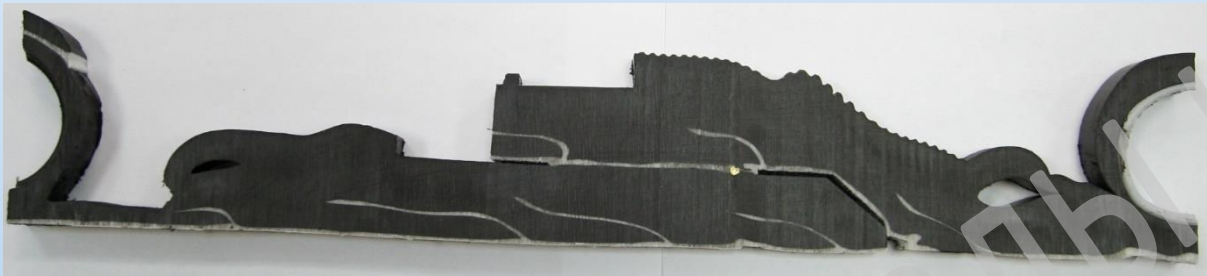
Сварной шов с одинарной спиралью в разрезе
