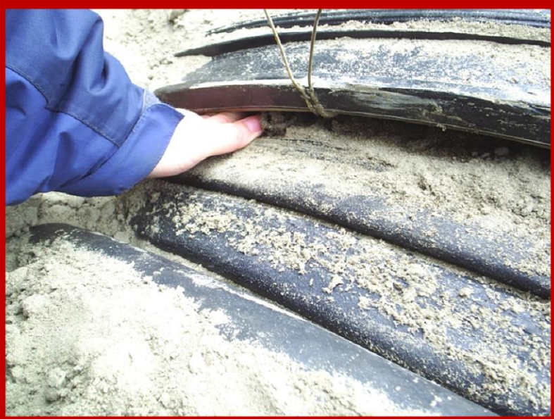
Не соответствие диаметров раструбной и спиготной части
