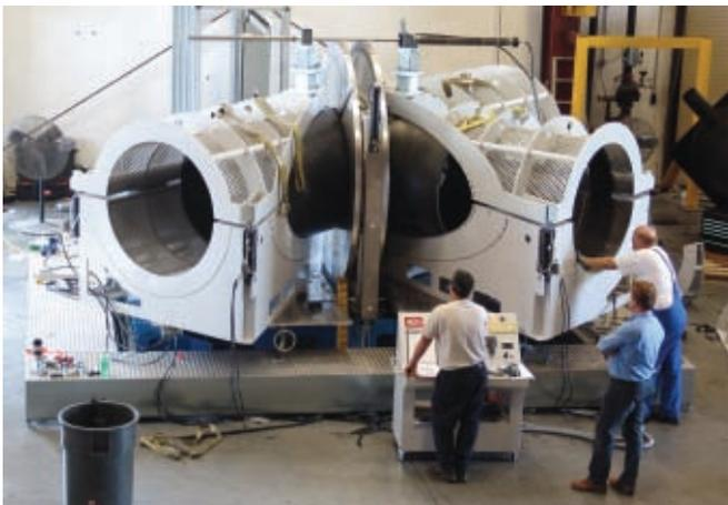
Машина DA 1200 с крановой установкой для торцевателя и нагревательного элемента
