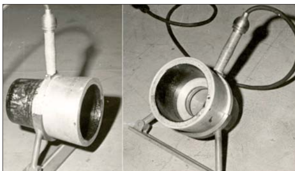
Рис. 7. Электронагревательный инструмент для контактной сварки труб из ПНД в конический раструб Производитель: Солнечногорский экспериментальный комплекс института «Оргэнергострой»; диаметры: 110–225 мм Рабочие поверхности имеют уклон 5° Перед сваркой на одной из труб формируется раструб
