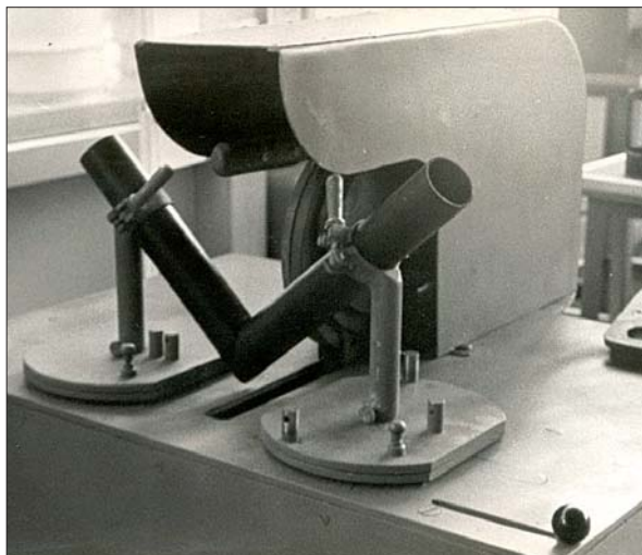
Рис. 6. Станок для контактной сварки труб и отводов Изготовитель: Монтажный завод № 3 Главмосстроя
