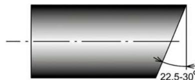
Рис. 28. Заготовка для второй операции производства Y-тройников
