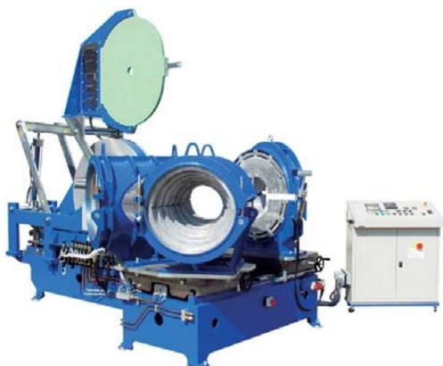
Рис. 3. Цеховая сварочная машина
