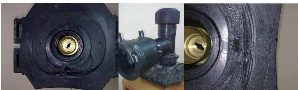
Рис. 2. Седелка 225x63мм без ответной части. Монтаж производился без зажима, седелка не была прижата должным образом к трубе, что привело к браку соединения.
