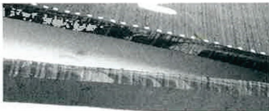
Рисунок Б 8 – Образец ПЭ с гладкой поверхностью разрушения
